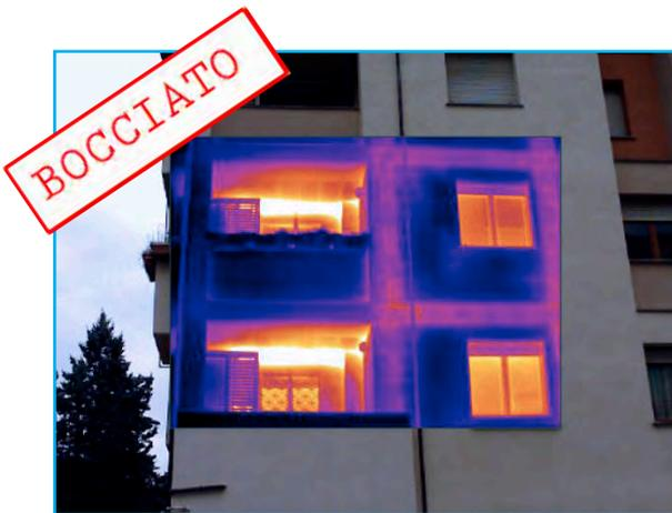
Nell' edificio residenziale analizzato è visibile grazie alle sfumature di colori arancio e rosa il comportamento termico della struttura. Le differenze di colori infatti disegnano perfettamente i profili dei pilastri e delle travi oltre a far intravedere l'orditura della facciata e dei solai delle verande. Sono inoltre evidenti perdite dai serramenti visibili in entrambe le immagini proposte.
