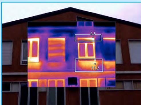
Nel riquadro in basso è visualizzabile, grazie alle differenze cromatiche, il comportamento del parapetto sollecitato, dall'interno, da un calorifero acceso posto sotto la finestra. Nell'area sovrastante vediamo la perdita nei serramenti caratterizzate sempre da colori caldi (Temperatura esterna -5° C).
