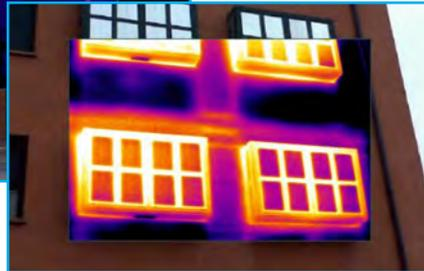
Anche in questo secondo edificio residenziale costruito intorno al 2002 sono evidenti ponti termici in corrispondenza delle strutture portanti verticali e orizzontali della facciata laterale orientata verso sud-est. Tali dispersioni sono messe in evidenza anche dalla presenza dei ponti termici in corrispondenza del telaio strutturale in cemento armato delle finestre.
