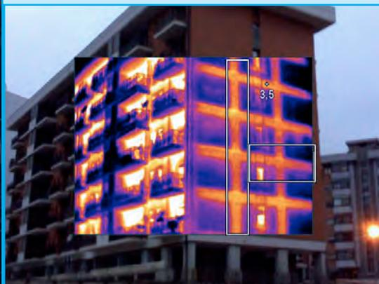
fotografati agli infrarossi con impianto di riscaldamento attivo. Si nota come a differenza dell'edificio di sinistra, in quello di destra siano presenti contrasti cromatici accentuati. Tali differenze di colore rappresentano il gradiente termico sulla superficie esterna dell'edificio (alle zone di colorazione più
